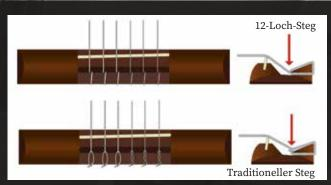
montato e una pressione di contatto uniforme della corda ottimizzano la trasmissione delle vibrazioni alla tavola armonica e quindi il suono della chitarra.
